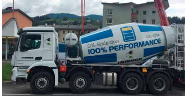
Besonders innovativ: Ein neuer Betonmischer-Prototyp der Firma Liebherr mit elektrischer Mischtrommel.
